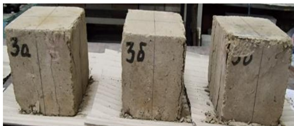
Рис. 6. Грунтобетонні зразки з рециклінговим щебнем після випробування на стиск:
