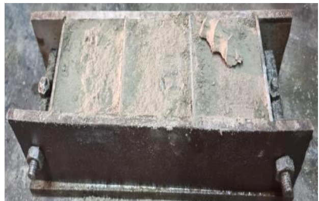
Рис. 5. Виготовлення ґрунтобетонних зразків із використанням рециклінгового щебеню
