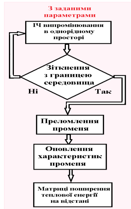
Рис. 2. Алгоритм поширення теплової енергії в однорідному повітряному середовищі (без аерогелів та аерозолів)
