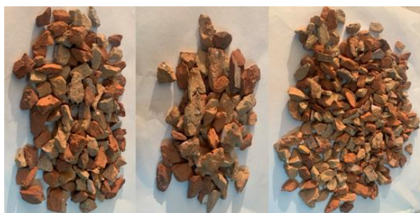
Рис. 6, а. Загальний вигляд залишків заповнювача на ситах з вічками 25, 20 і 15 мм відповідно
