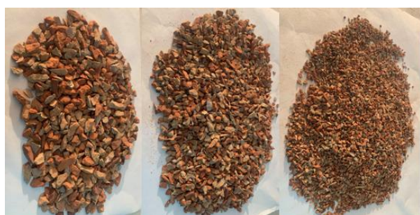
Рис. 6, б. Загальний вигляд залишків заповнювача на ситах з вічками 10, 5 і 2,5 мм відповідно
