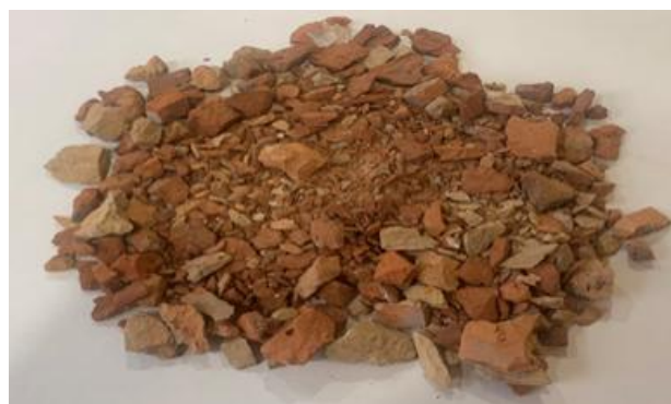
Рис. 5. Загальний вигляд заповнювача, отриманого після подрібнення цегли
