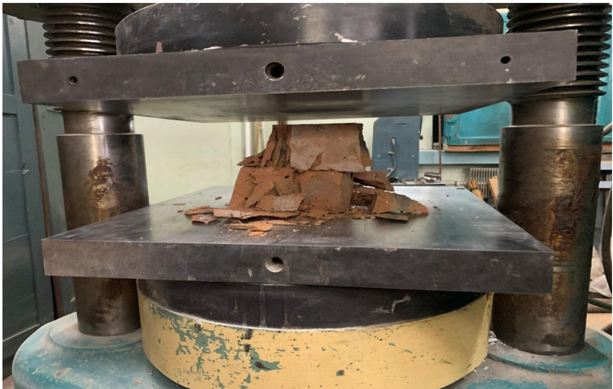
Рис. 4. Випробування половинок цегли глиняної звичайної на стиск на пресі П-125
