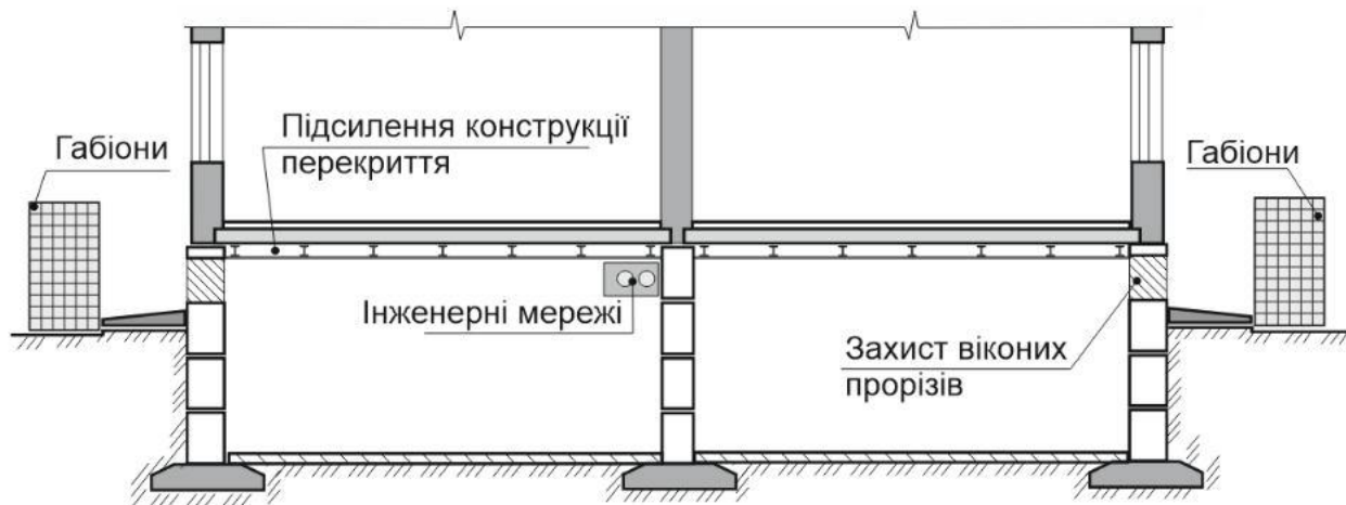
Рис. 2. Укриття в підвалі цегляних будинків з перекриттям пустотними залізобетонними плитами [1]
