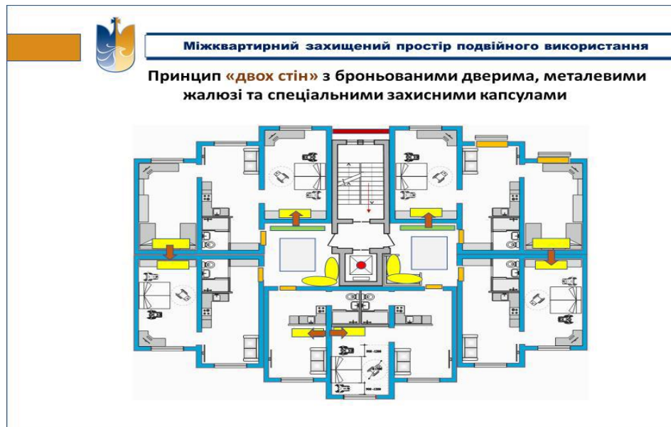
Рис. 15. План міжквартирного захищеного простору у житловому будинку [5]
