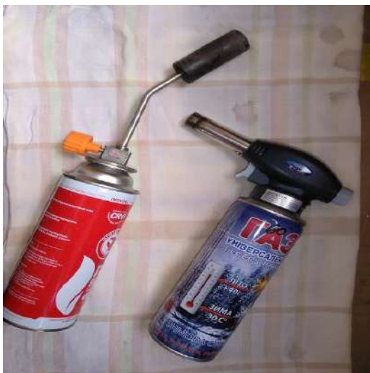
Рис. 8. Мініпальники, що використовуються для заклеювання розтину килима
