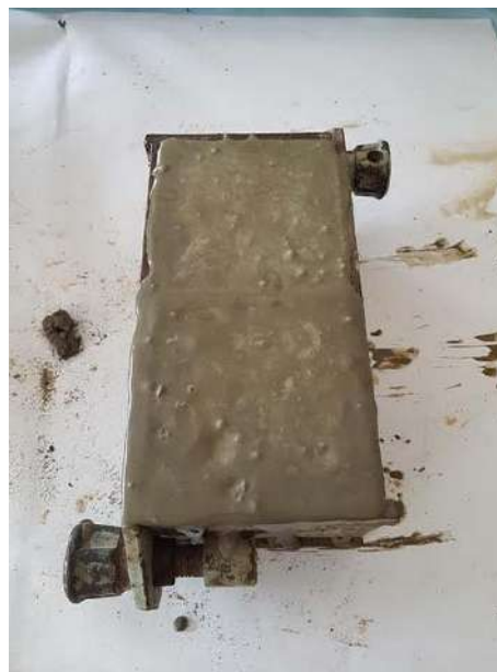
Рис. 6. Форма для виготовлення бетонних кубів, заповнена бетонною сумішшю, з розміщеними на дні зразками тканини
