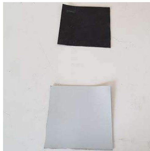
Рис. 4. Зразки матеріалів для виготовлення пневмоопалубки
