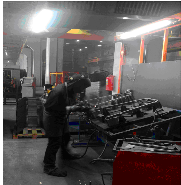
Рис. 3. Модернізований зварювальний стіл електрозварника
