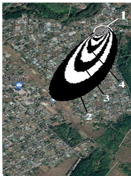
Рис. 6. Зона хімічного забруднення, V = 6,8 м/с, t = 143 с: 1 – джерело емісії; 2 – C = 17 мг/м 3 ; 3 – C = 28 мг/м 3 ; 4 – C = 45 мг/м 3
