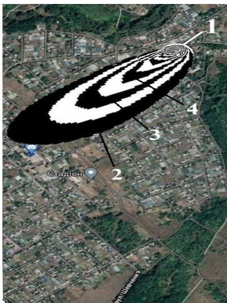
Рис. 5. Зона хімічного забруднення, V = 4,8 м/с, t = 243 с: 1 – джерело емісії; 2 – C = 16 мг/м 3 ; 3 – C = 28 мг/м 3 ; 4 – C = 47 мг/м 3
