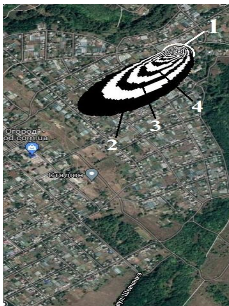
Рис. 4. Зона хімічного забруднення, V = 4,8 м/с, t = 130 с: 1 – джерело емісії; 2 – C = 15 мг/м 3 ; 3 – C = 29 мг/м 3 ; 4 – C = 46 мг/м 3
