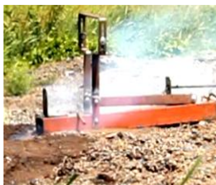
Рис. 4. Фотографія пристрою у момент ініціювання сповільнювача підричника гранати
