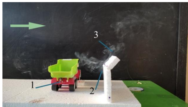
Рис. 1. Зона забруднення: 1 – джерело викиду; 2 – зона забруднення перед бар'єром; 3 – зона забруднення над додатковим елементом
