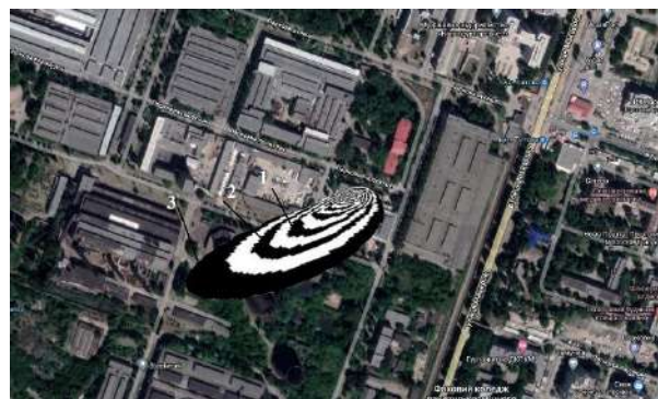
Рис. 3. Зона хімічного забруднення, t = 58 \text{ с} 1 – C = 51 \text{ мг/м}^3 ; 2 – C = 29 \text{ мг/м}^3 ; 3 – C = 15 \text{ мг/м}^3
