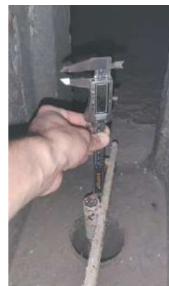
Рис. 6. Визначення деформації палі u_{pile} : а – схема деформування; б – визначення u_{pile} за допомогою штангенциркуля
