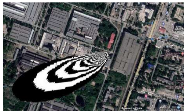
Рис. 4. Зона хімічного забруднення, t = 97 \text{ с} 1 – C = 47 \text{ мг/м}^3 ; 2 – C = 21 \text{ мг/м}^3 ; 3 – C = 12 \text{ мг/м}^3
