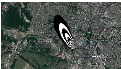
Рис. 7. Зона хімічного забруднення, t = 854 с 1 – C = 29 мг/м 3 ; 2 – C = 16 мг/м 3 ; 3 – C = 9 мг/м 3
