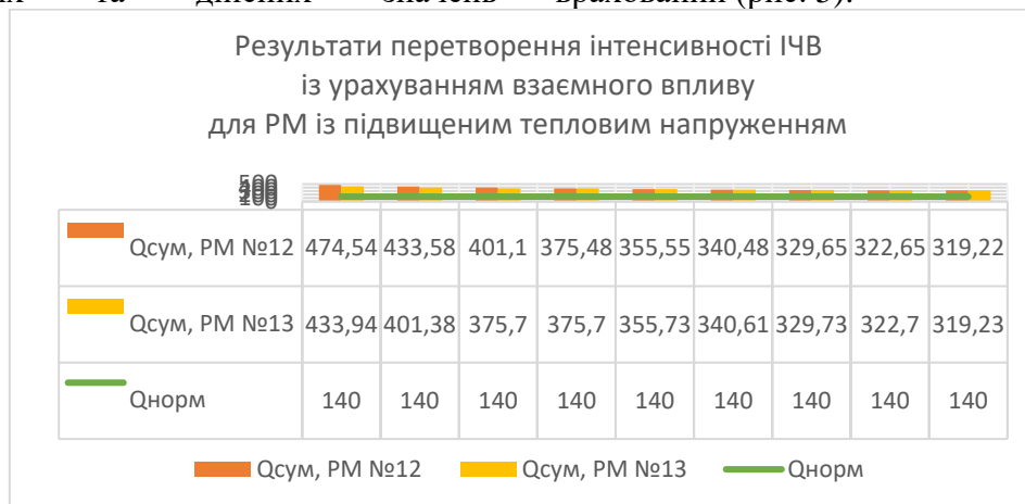
Рис. 5. Зміна значень інтенсивності ІЧВ на РМ електрозварників (РМ № 12, РМ № 13) залежно від відстані
