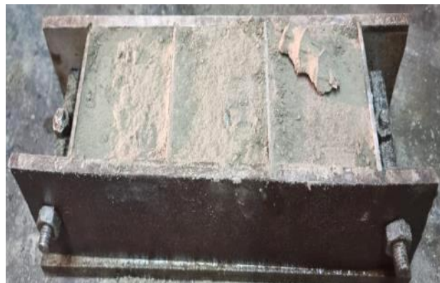
Рис. 5. Виготовлення ґрунтобетонних зразків із використанням рециклінгового щебеню
