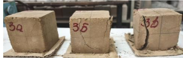
Рис. 3. Випробувані на стиск зразки ґрунтобетону
