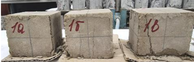
Рис. 3. Випробувані на стиск зразки ґрунтобетону
