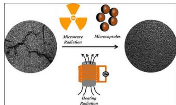
Рис. 8. Методи самовідновлення асфальтових покриттів [22]
