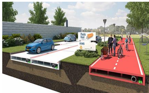
Рис. 2. Дороги із збірних пластикових панелей
