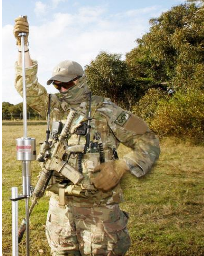
Рис. 3. Робота оператора з пенетрометром DCP Model K100 M
