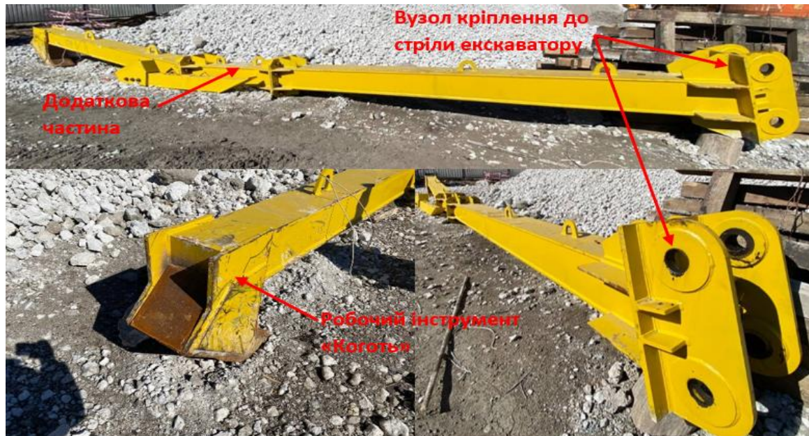
Рис. 9. Фото подовжувача стріли на площадці зберігання
