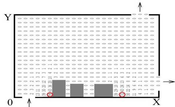
Рис. 3. Область забруднення в робочому приміщенні t = 0,24\text{ с} , C_{\max} = 0,61\text{ г/м}^3
