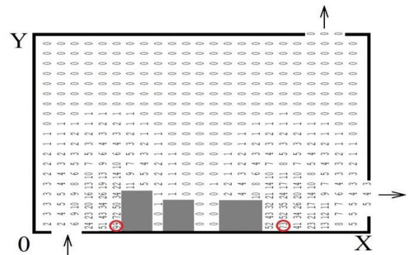
Рис. 4. Область забруднення в робочому приміщенні, t = 0,71\text{ с} , C_{\max} = 0,87\text{ г/м}^3
