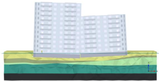
Модель ґрунтової основи з однаковою стисливою товщею Секція 1 – 11 поверхів, Секція 2 – 8 поверхи
