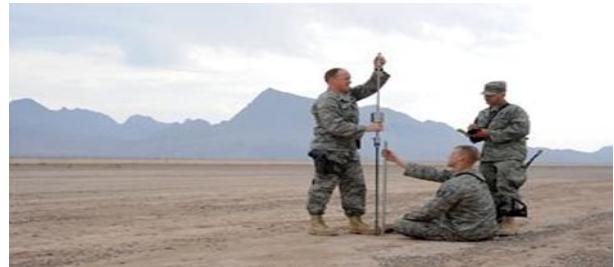
Рис. 1. Застосування пенетрометрів інженерними підрозділами армії США для контролю ґрунтової основи
