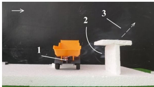
Рис. 3. Експериментальне дослідження зон забруднення з використанням бар'єру Т-форми: 1 – місце емісії CO; 2 – область забруднення під пластиною; 3 – область забруднення над пластиною [3]
