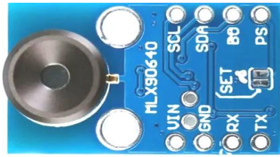
Рис. 2. Зовнішній вигляд інфрачервоної камери MLX90640-D110
