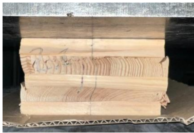
Рис. 6. Характер руйнування зразків ПКД при випробуванні на стиск : а – паралельно площині шарів; б – перпендикулярно площині шарів
