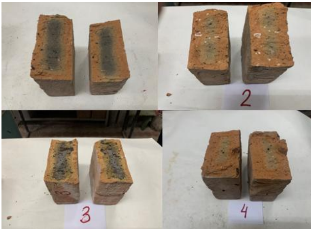
Рис. 3. Структура внутрішньої поверхні зразків з цегли глиняної звичайної (№ 1–4) після випробування на згин
