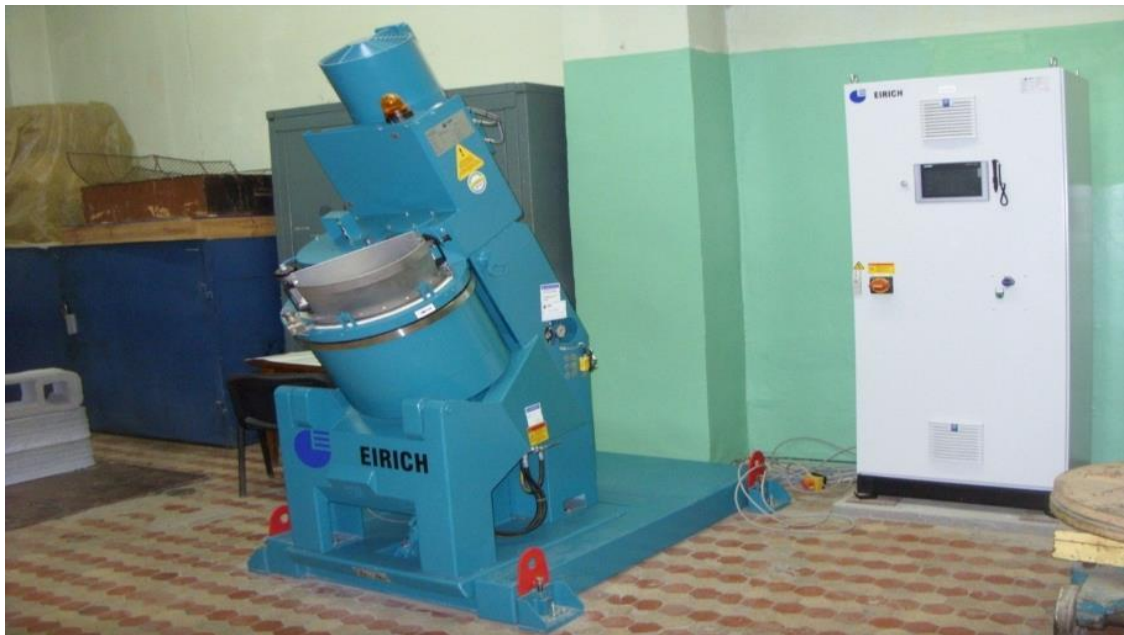
Рис. 1. Загальний вигляд бетонозмішувача марки «Айріх»
