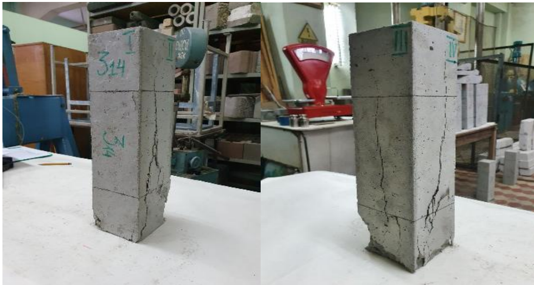
Рис. 6. Характер руйнування бетонної призми складу №3 (3 14 ), виготовленої при часі перемішування суміші 180 с, по гранях I-II і III-IV
