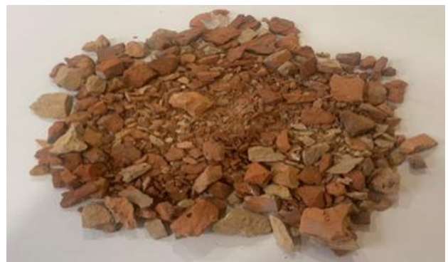
Рис. 5. Загальний вигляд заповнювача, отриманого після подрібнення цегли
