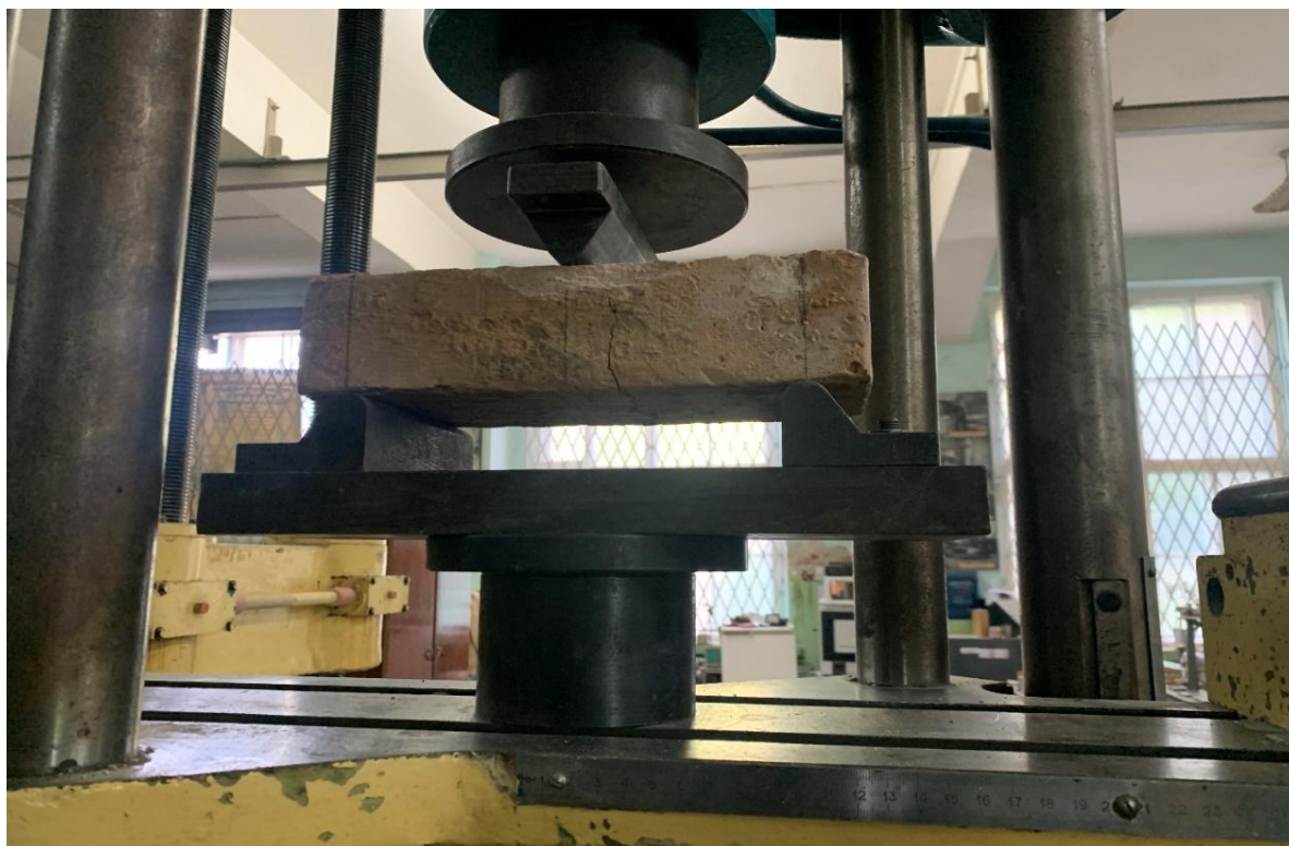
Рис. 2. Випробування цегли глиняної звичайної на згин на пресі УММ-20
