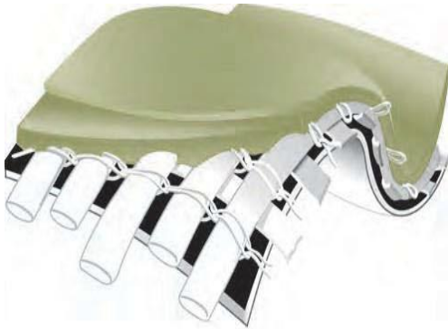
Рис. 4. Архітектурна мембрана на основі ПВХ
