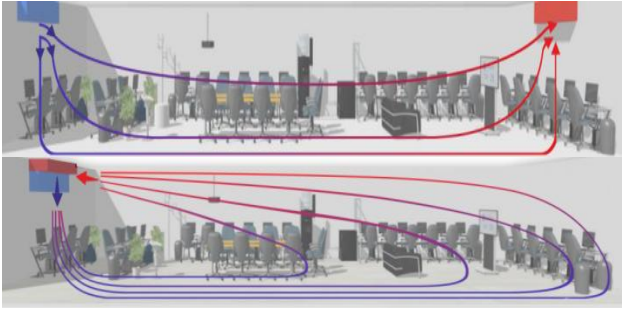
Рис. 3 Схема реалізації комбінованої притяжно-витяжної вентиляції для унормовування тепловологісних показників Open Space приміщень підземного розташування
