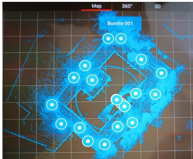
Рис. 5. План-схема будівлі з кількістю стоянок збору даних
