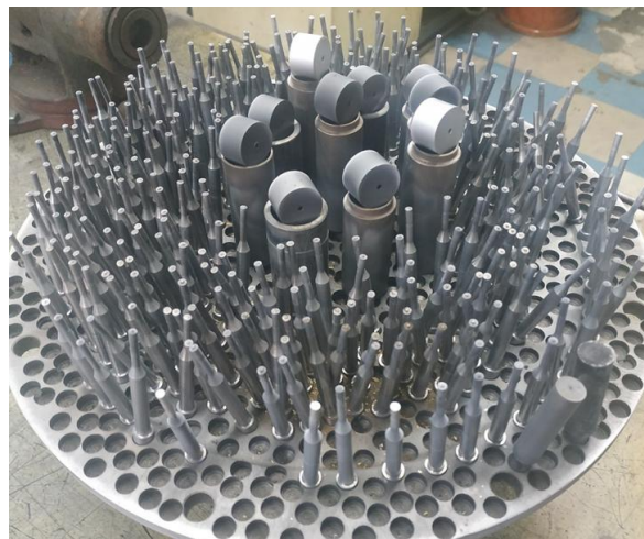
Рис. 6. Вигляд садки для процесу іонного азотування
