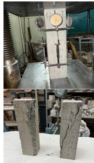
Рис. 3. Загальний вигляд зразків-призм до та після випробування на визначення модулю пружності
