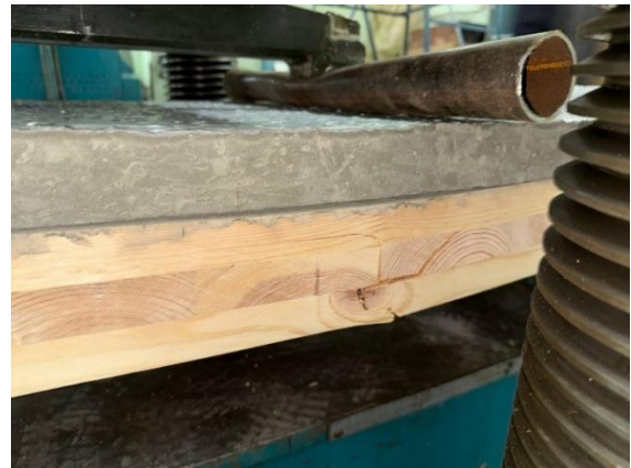
Рис. 6. Руйнування конструкції під час випробування
