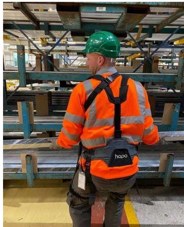
Рис. 4. Використання екзоскелета Наро Васк під час маніпуляцій з важкими металевими профілями на складі
