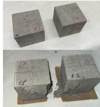
Рис. 2. Загальний вигляд зразків-кубів до та після випробування на стиск
